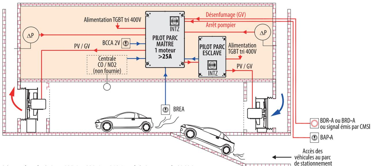
Possibilité de remplacer les boîtiers BRE-A + BDR-A + BAP-A par le boîtier centralisé BCC-P.
