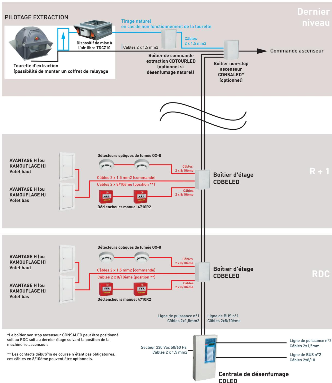
\*Le boîtier non stop ascenseur CDNSALED peut être positionné soit au RDC soit au dernier étage suivant la position de la machinerie ascenseur.
