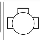
• Permet de raccorder 1, 2 ou 3 piquages Ø 125 mm à un réseau de ventilation.
