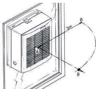
Les valeurs données, dans le tableau des caractéristiques sont des niveaux de pression sonore, mesurées à 3 m en dB(A) et appareil monté. Ci-après sont indiquées les corrections à apporter pour déterminer les spectres de puissance sonore -LWS- à l'aspiration et au soufflage en grande vitesse (en Hz).
