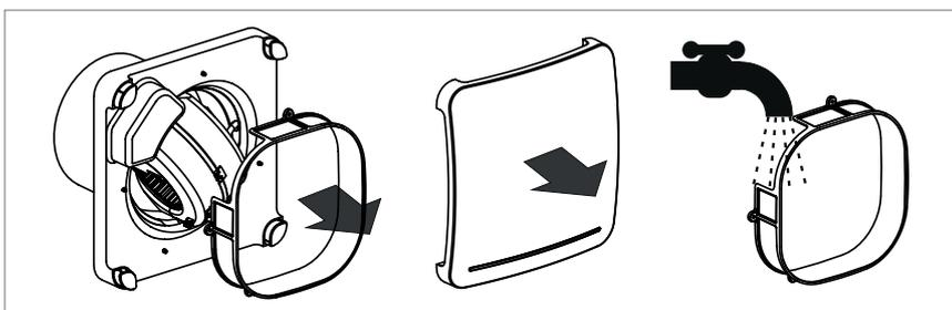
\* Démontage encore plus simple et nettoyage facile à la main ou sous le robinet et au lave-vaisselle.
