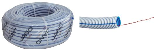
Système de conduit annelé Polypropylène coextrudé blanc à bandes bleues, non propagateur de la flamme FRLSOH, transversalement élastique pour la protection des fils et câbles.
