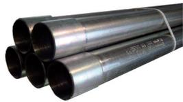
Conduit rigide lourd en acier électrozingué résistance aux chocs élevée IK 10, > 20 Joules à -45°C, résistance à l'écrasement > 4000N, températures d'utilisation de -45°C à +400°C. Le conduit MRL en acier électrozingué est utilisable dans les locaux industriels, partout où une protection mécanique est nécessaire (ou pour les atmosphères à risques types déflagration, incendie) jusqu'à 1.50m du sol.
