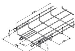
Fini les éclisses et les boulons : l'assemblage du CITO est automatique et offre une résistance identique à un éclissage classique.
