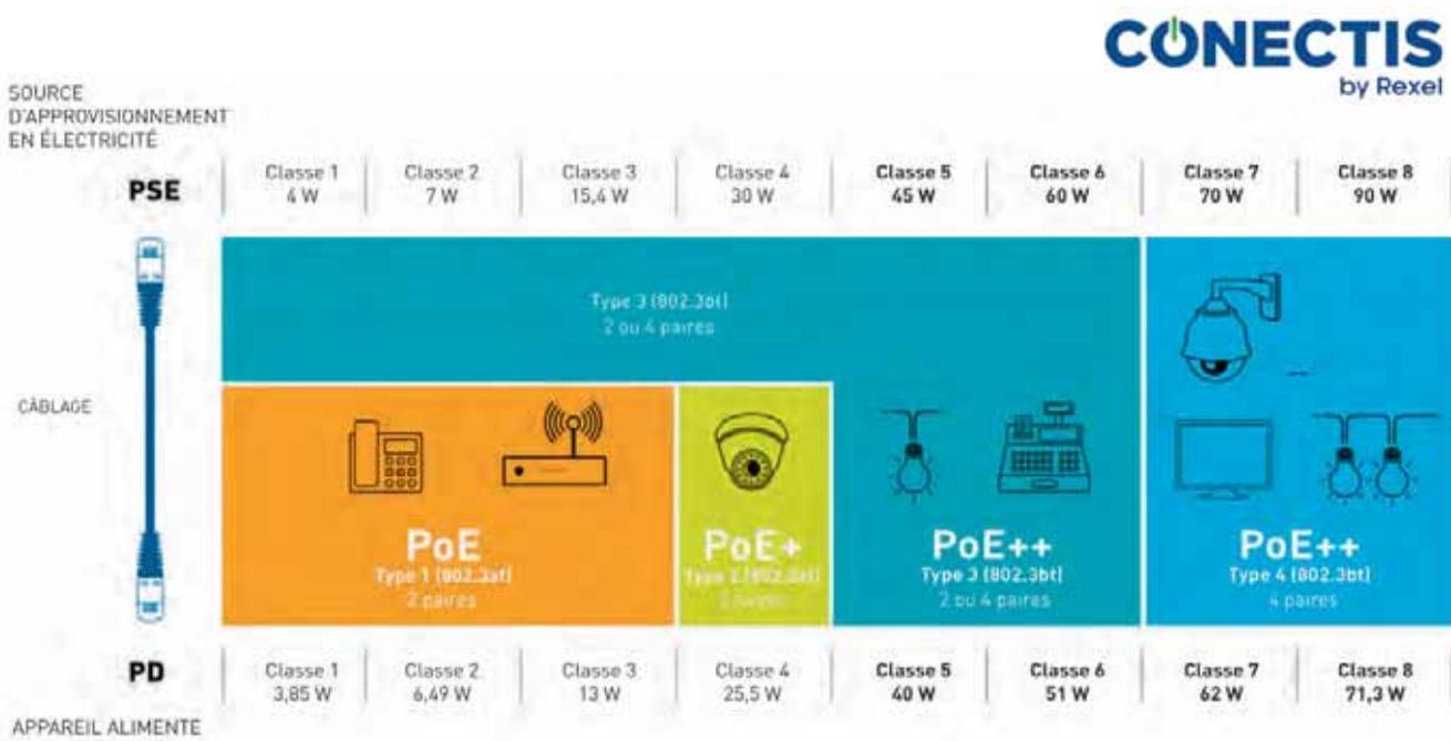
Aussi, il est important de prendre en considération les pertes par effet joule liées au réchauffement du câble sur les 2 paires (type 1, 2 ou 3) ou 4 paires (type 3 ou 4) mises en œuvre et à l'intensité de l'alimentation électrique.
