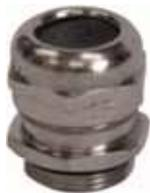
NEWCAP est une gamme de presse-étoupe en laiton nickelé, avec joint torique et équipés d'une bague de serrage en PVC qui garantit une étanchéité IP68 sur la gaine extérieure de câbles ronds non armés ou de câbles blindés ainsi qu'une parfaite résistance à la traction.
