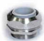
JUDODIX est la gamme de raccords venant compléter l'offre de gaines flexible métalliques CAPRIPLAST. Assurant la tenue de la gaine par l'intérieur et l'extérieur de celles-ci, les raccords JUDODIX garantissent un IP66 au niveau de la jonction gaine/raccord et également IP66 au niveau du filetage, mâle ou femelle, par l'ajout d'un joint plat néoprène.
