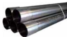
Conduit rigide lourd en acier électrozingué résistance aux chocs élevée IK 10, > 20 Joules à -45°C, résistance à l'écrasement > 4000N, températures d'utilisation de -45°C à +400°C.
