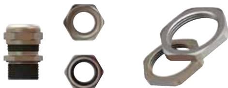
Presse-étoupe métal filetage ISO avec réducteur d'effort et joint de haute qualité. Corps et capuchon en laiton nickelé, bague d'étanchéité en caoutchouc chloroprène, bague de serrage en PA 6.
