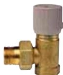
1 La soupape différentielle de décharge s'ouvre en établissant un by-pass entre le départ et le retour, lorsque les robinets thermostatiques ou les vannes de zone se ferment. Cela permet au circulateur de ne pas forcer et supprime les bruits dans l'installation
