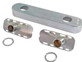
Ax'O est un adaptateur d'entraxe universel pour robinetterie de douche et bain-douche qui permet de compenser des entraxes allant de 55 à 130 mm et de poser une robinetterie d'entraxe 150 mm (mitigeur mécanique, thermostatique et mélangeur) sur toutes les installations à rénover avec une étanchéité assurée par des joints plats intégrés testés et approuvés par nos experts.
