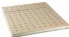
L'élément principal du système Exact est une dalle isolante en polyuréthane revêtue sur ses deux faces d'une couche étanche et qui est recouverte d'une chape flottante chauffante ou rafraichissante dans laquelle sont noyés des tubes en matériau de synthèse permettant la circulation d'eau.
