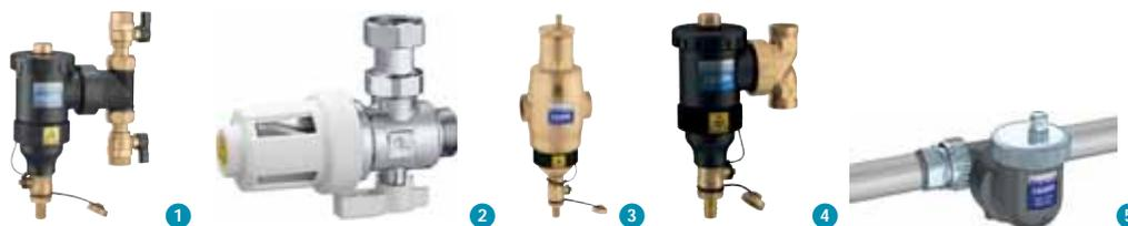
Le pot de décantation DIRTMAG 545 recueille en continu les boues et impuretés de l'eau de chauffage. L'anneau magnétique amovible piège particulièrement les particules métalliques en suspension. Le corps en matériaux de synthèse se monte facilement sur une conduite horizontale ou verticale. Séparation des particules jusqu'à 5µm
