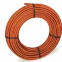
Les tubes PER avec BAO (barrière anti-oxygène) de COMAP sont recommandés pour les installations de chauffage et de plancher chauffant. La barrière anti-oxygène, composée d'une couche d'EVOH (Copolymère éthylène alcool vinylique) empêche l'oxygène de s'infiltrer. Elle limite ainsi la formation de boues dans les réseaux et favorise une plus grande longévité des tubes dans les installations.
