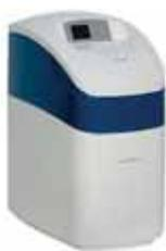
BWT PERLA SILK S. Très fin et peu profond (LxHxP mm : 276x256x470). 10L de résine, débit 1,44m<sup>3</sup>/h. Electrovanne anti-débordement, régénération volumétrique anticipée. Garantie 10 ans (corps, bac à sel, résines). Mise en service incluse.
