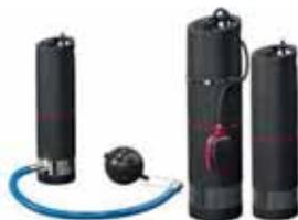
La Grundfos SBA est une unité tout-en-un. Son contrôleur de pression intégré lui permet de démarrer et de s'arrêter dès ouverture ou fermeture du robinet et ou selon présence d'eau ou pas dans le puits ou la réserve. Elle est protégée contre le manque d'eau. La SBA est donc réellement une solution «plug & pump». Une fois installée et raccordée, il suffit de brancher la pompe sur le secteur et de l'enclencher.
