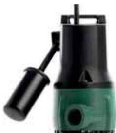
Pompe vide cave NOVA 300R Automatique Alimentation électrique : 230 V - 0,22 kW - 1,5 A - Débit max : 9 m<sup>3</sup>/h - Hauteur maxi de relevage : 7 m - Refoulement 1 1/4 M - livré avec 5 mt de câble.
